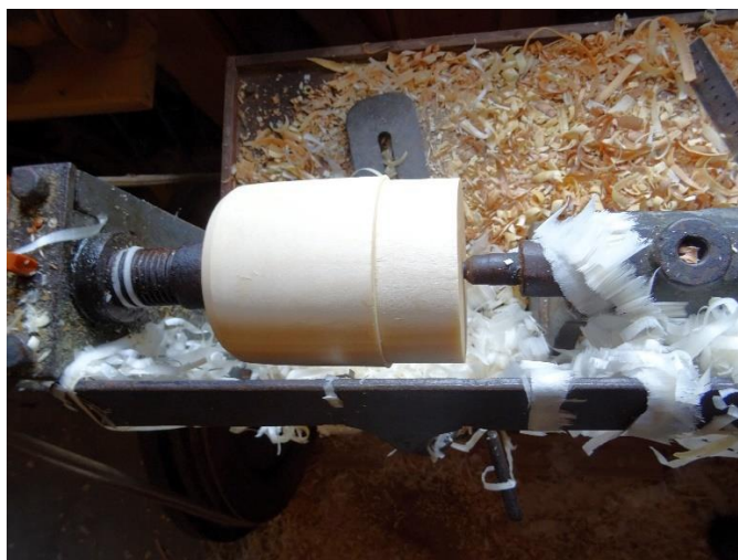
Izvirpotā vilcējkanniņas sagatave (E. Žīgura foto)
