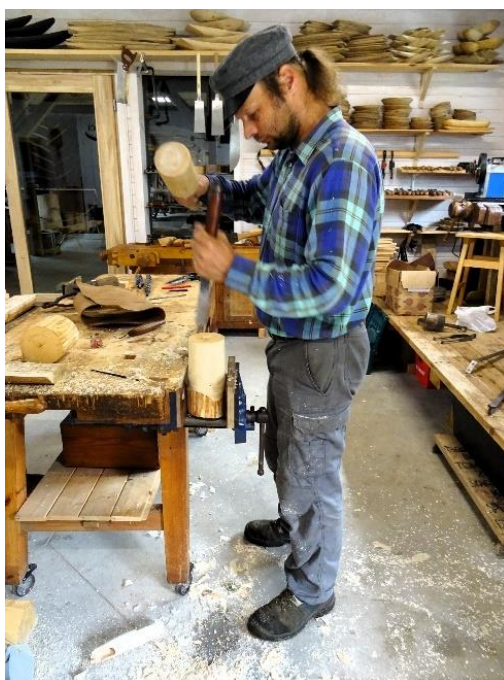
Apakšējās kanniņas (pretvārsta) sagatavošana (E. Žigura foto)
