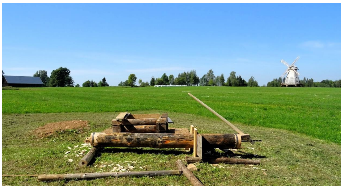
Sūknis ar piestiprinātiem atbalsta dēļiem (E. Žigura foto)
