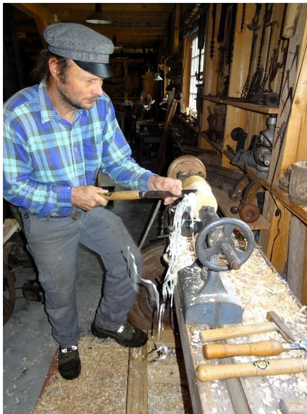
Apakšējās kanniņas (pretvārsta) virpošana (E. Žīgura foto)
