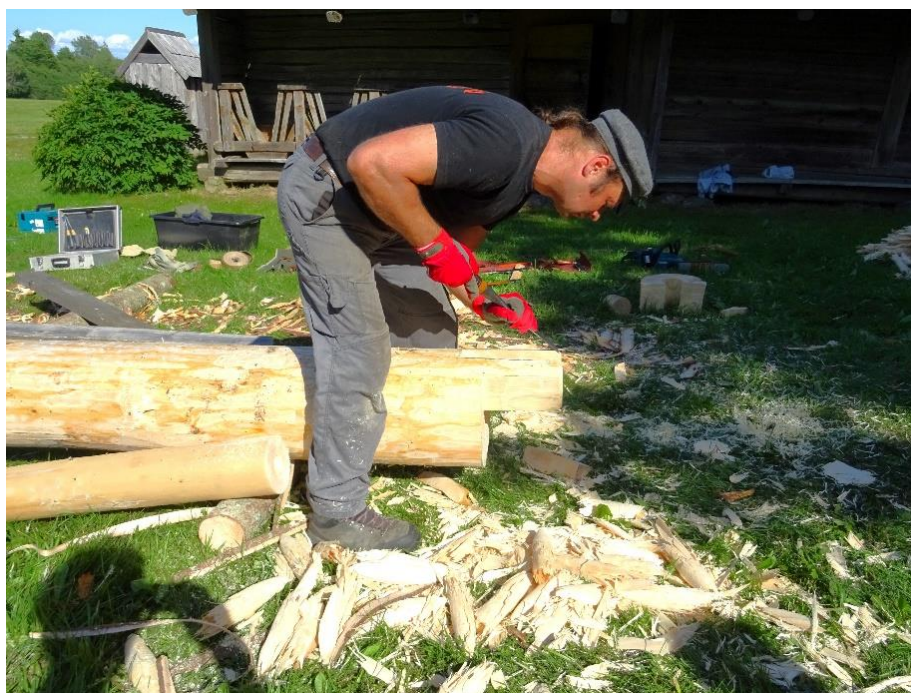
Sūkņa roktura stiprināšanas vietas sagatavošana (E. Žigura foto)
