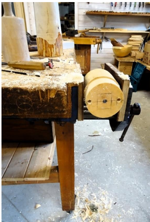
Vilcējkanniņas sagatave ar stiprinājumam paredzētajiem caurumiem (E. Žīgura foto)
