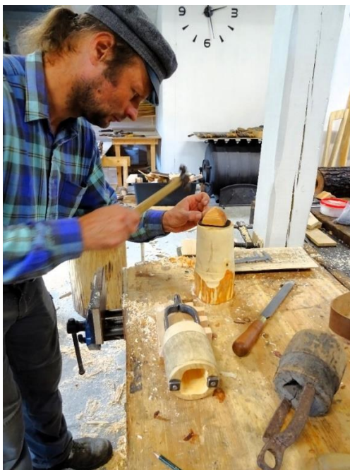
Kanniņas (pretvārsta) vāciņa nostiprināšana (E. Žīgura foto)
