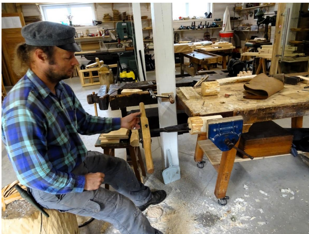
Apakšējās kanniņas (pretvārsta) sagatavošana (E. Žigura foto)
