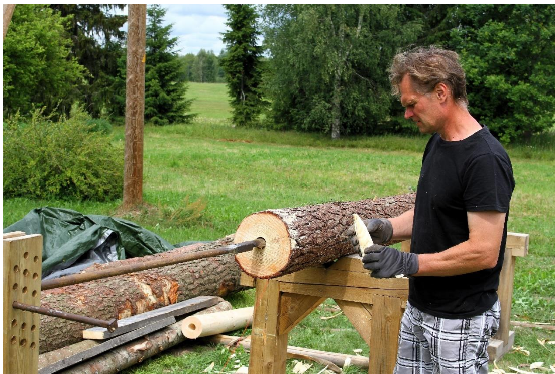
Urbuma precizitātes noteikšana pēc izurbtās skaidas (V. Grīviņa foto)
