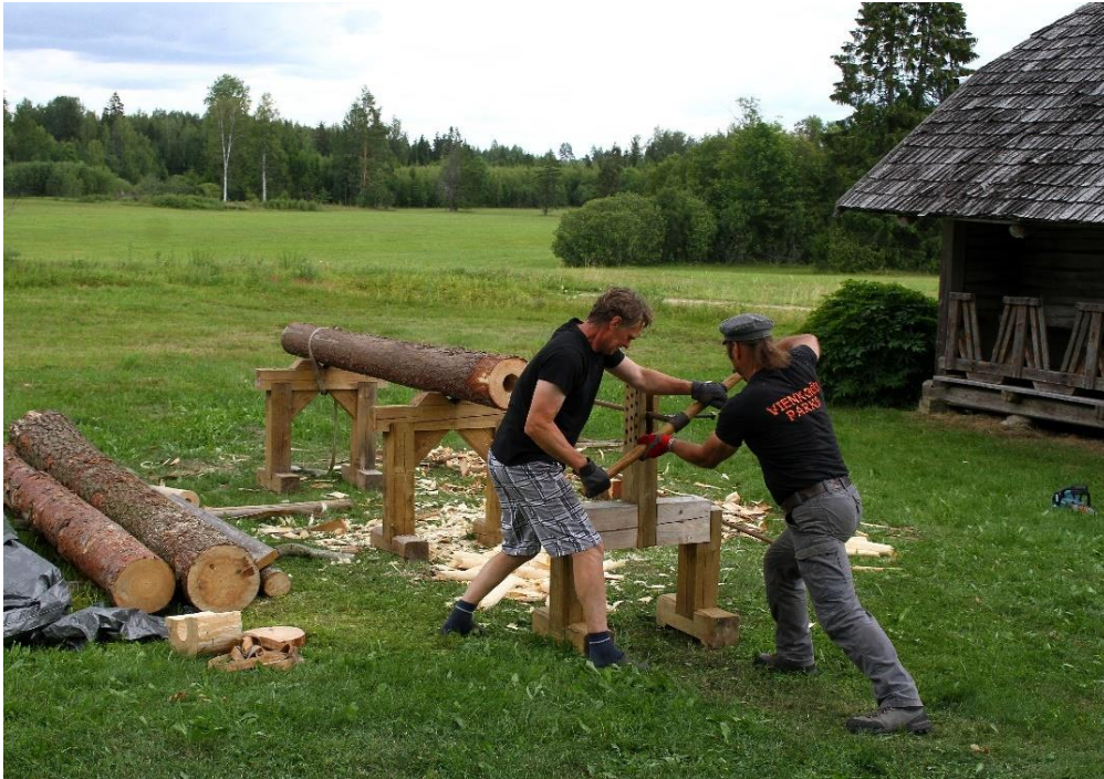
Urbšana ar 10 cm diametra urbi dubultiem spēkiem (V. Grīviņa foto)
