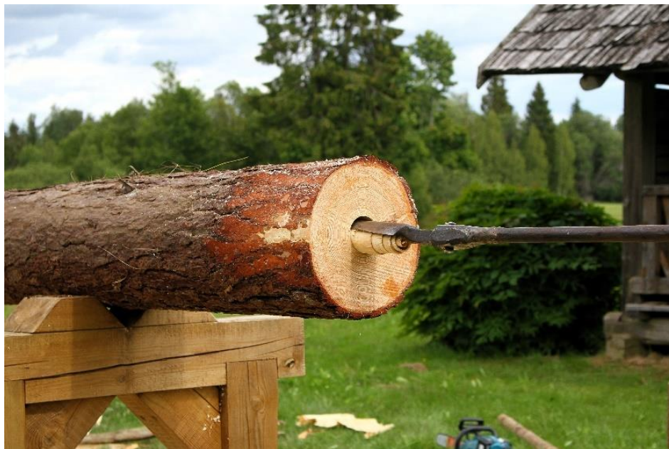
Urbja izvilšana ar skaidu (V. Grīviņa foto)
