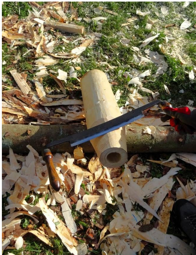
Ūdens iztekas caurules sagatavošana ( E. Žīgura foto)
