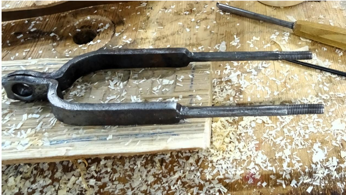
Stiprinājums vilcējkanniņas turēšanai (E. Žigura foto)
