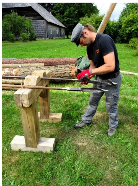
Urbju (5 un 8 cm diametrs) iestiprināšana rokturī (stienī) (E. Žīgura foto)
