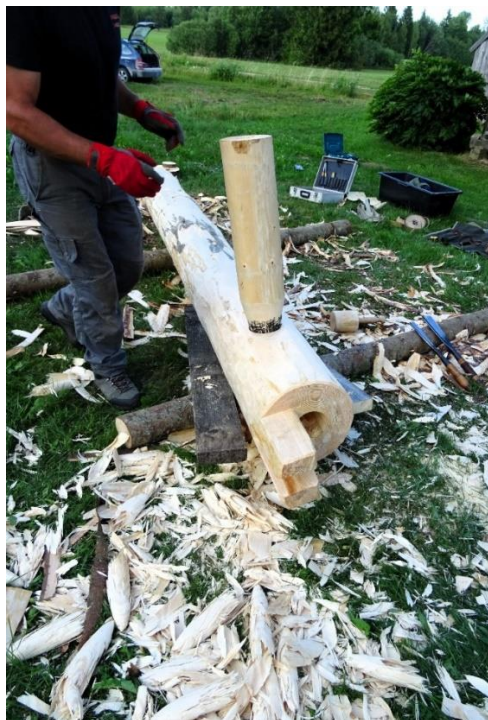
Ūdens iztekas caurules iestiprināšana atzīmējot ar ogli ( E. Žīgura foto)
