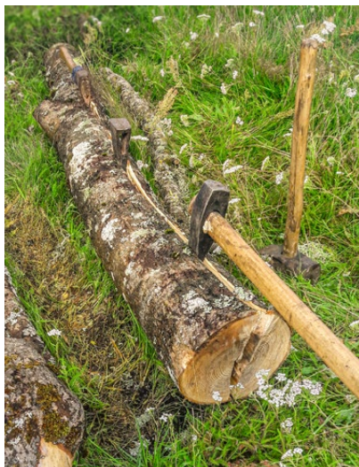
4. att. Oša koka šķelšana liektajām sliecēm. Foto, U. Bērente, 2019
