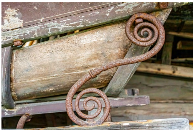
18. att. Kamanas. Sānos no apaļmetāla stieples dekoratīvi izliekta saturmietne no kulbas daļas līdz spārņiem. Vidzeme. BDM 2163. Foto, M. Ķilkuts, 2022
